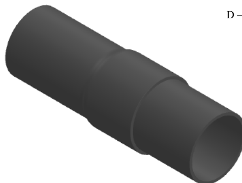
Rys. 7 Kielichowe łączenie rur gładkich
