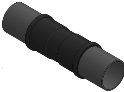
Rys. 6 Łączenie rur gładkich za pomocą złączki ZROS
