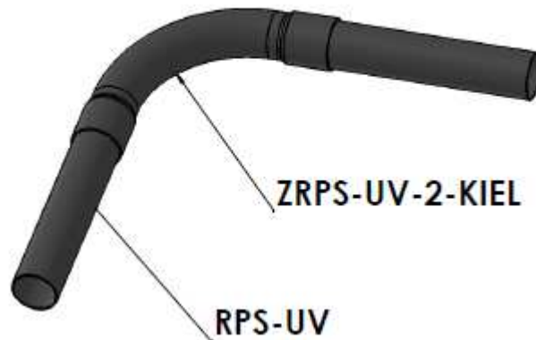
Rys. 13 Połączenie kolanem dwukielichowym
